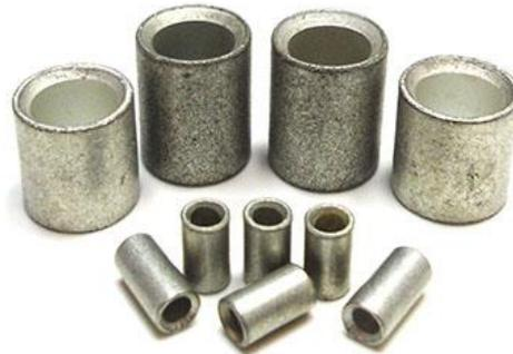
**Verwendung** Parallelverbinder werden zum Zusammenführen von fein- und feinstdrätigen Leitungen mit verschiedenen Querschnitten verwendet. Bei Parallelverbindern werden die Litzen der Kabel parallel zueinander gelegt und miteinander verpresst. Der Parallelverbinder bietet dabei die Möglichkeit, die Kabel von zwei gegenüber liegenden Seiten aus einzuführen. Somit werden beide Kabel vom Verbinder abgeführt, ohne dass die Gefahr des Abknickens entsteht.
