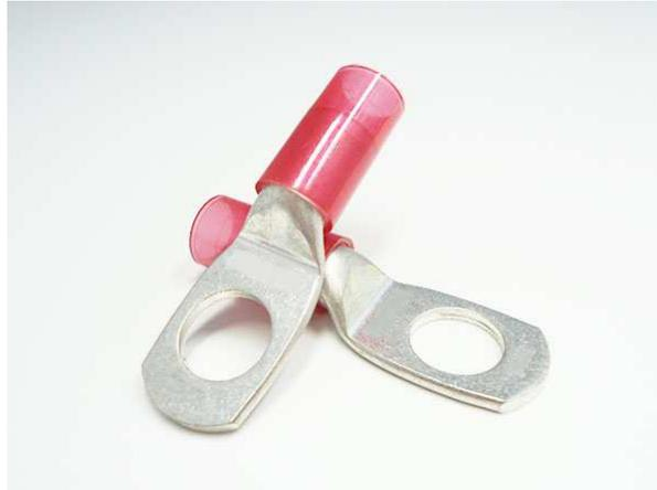
**Verwendung** Scorlink - Rohrkabelschuhe werden zum Abschluss von Kabelführungen verwendet und stellen eine elektrische Verbindung zwischen dem Kabel und dem anzuschließenden Gerät her. Sie werden anders als andere Kabelschuhe nicht aus einem Blech gestanzt und geformt, sondern aus einem Rohr hergestellt. Dies führt unter anderem zu einer besseren Leitfähigkeit. Die Lochbohrungen der Scorlink - Rohrkabelschuhe sind kompatibel mit Gewinden von Schrauben, Stiften und Bolzen von M4 bis M20.
