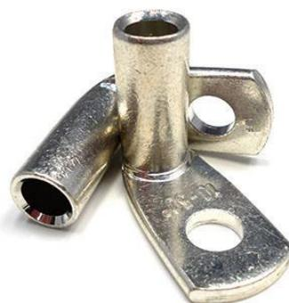
**Verwendung** scorklink - Winkelkabelschuhe werden zum Abschluss von Kabelführungen verwendet und stellen eine elektrische Verbindung zwischen dem Kabel und dem anzuschließenden Gerät her. Sie werden anders als andere Kabelschuhe nicht aus einem Blech gestanzt und geformt, sondern aus einem Rohr hergestellt. Dies führt unter anderem zu einer besseren Leitfähigkeit.
